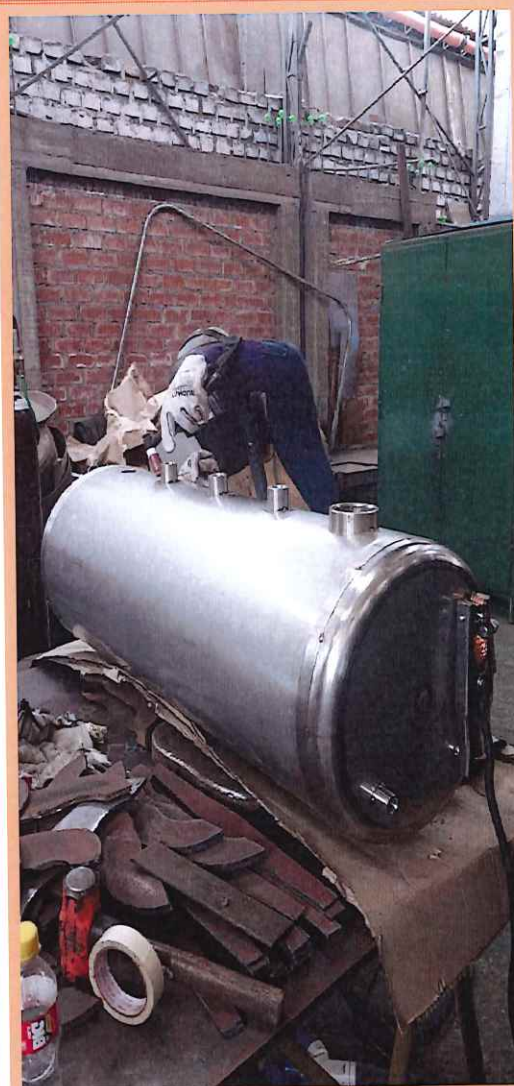
DETALLE: Fabricación del tanque de acero inoxidable
